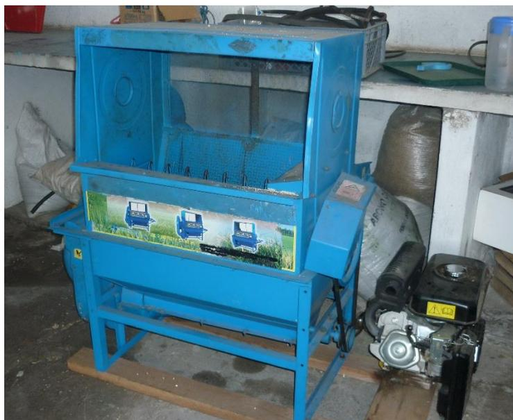
**Figura 2.** Equipo de trilla tipo cilindro y cóncavo
