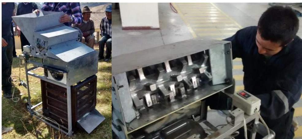
**Figura 3.** Prototipo y sistema de trilla
